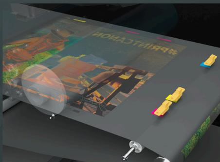
O **sistema de correção de cores Multi-D.A.T.**, que corrige e fornece automaticamente cores consistentes e estáveis em todas as páginas, independentemente da dimensão do trabalho de impressão e sem qualquer intervenção do operador.
